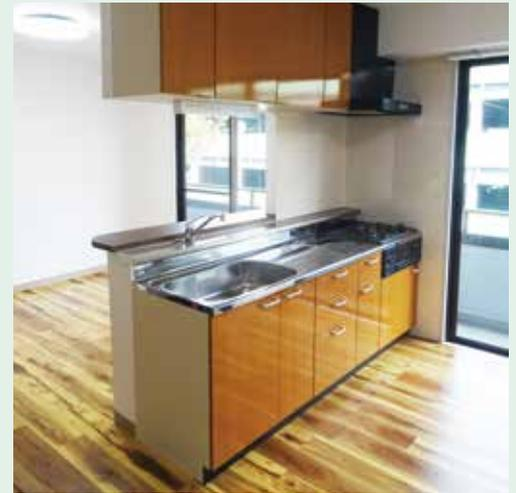
上記施工では、キッチン本体を変更。壁を壊しDKからLDKに変え、カウンターキッチンに変更。
